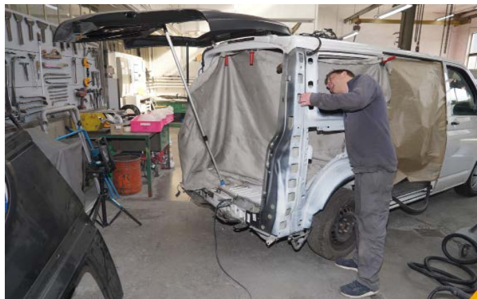
Die Scheiwiller AG erledigt auch komplizierteste Reparaturen wie den Austausch der hinteren Säule dieses Lieferwagens.
