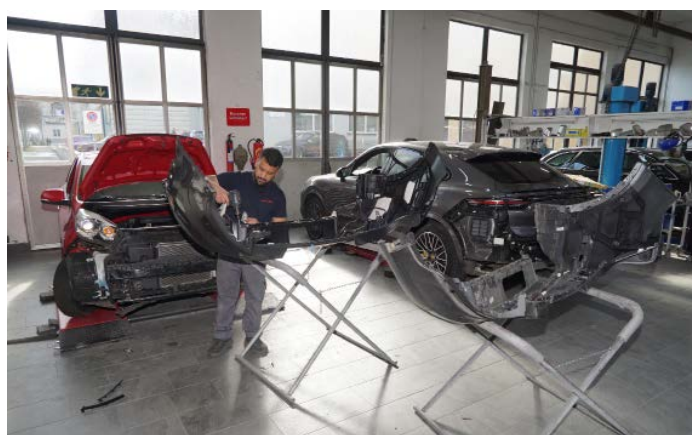
Auch Kunststoffteile wie Frontspoiler werden wieder instand gesetzt.
